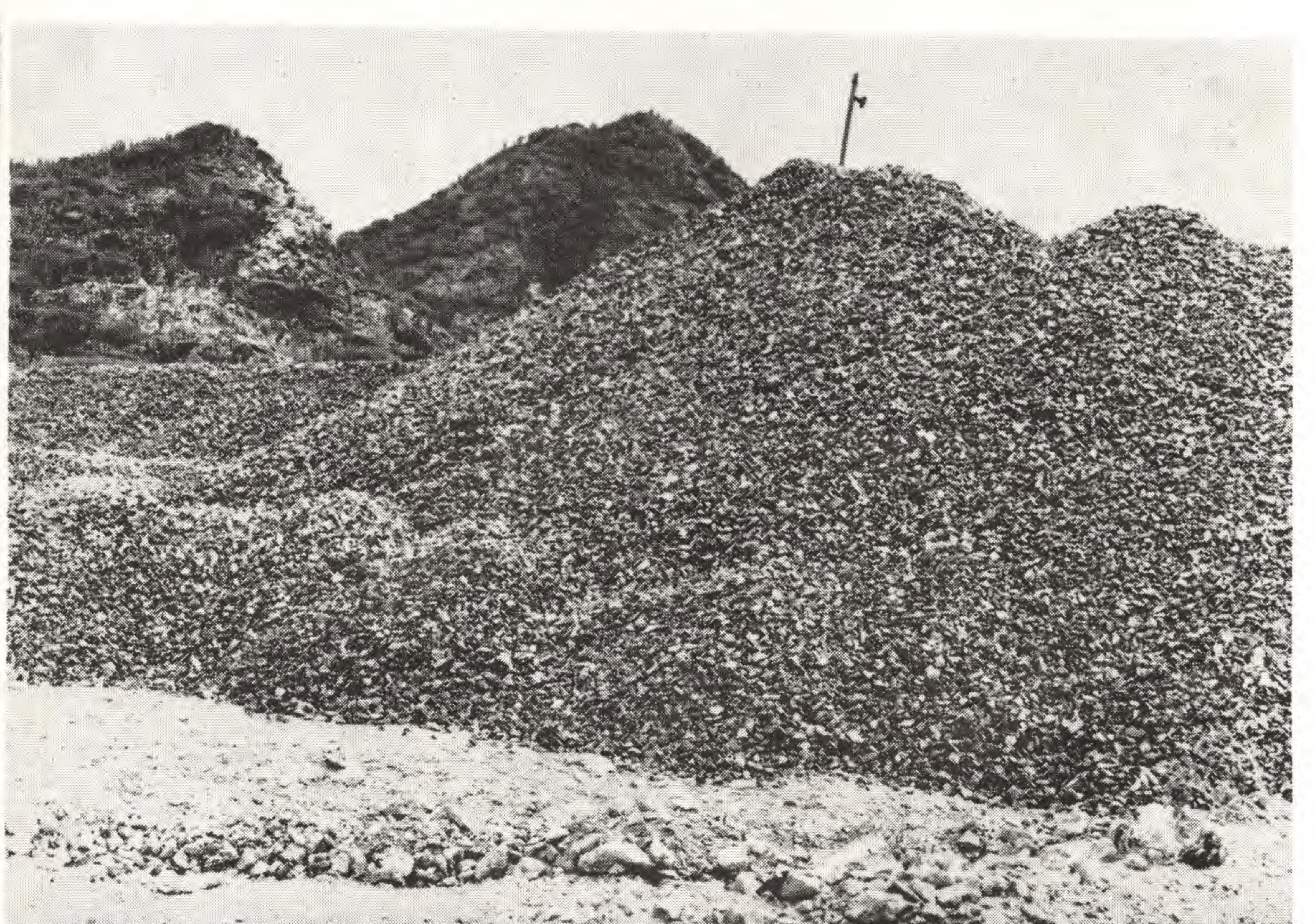
Steenslag No. 3 die tot No. 5 zal worden verwerkt t.b.v. de hydroponics-groeibedden.
